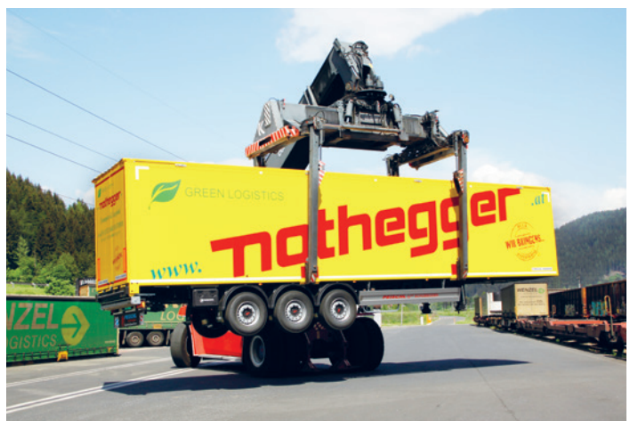
Schubboden-Sattelaufleger in kranbarer Ausführung für die Bahn.
