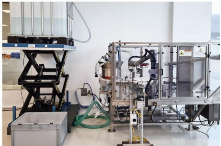
Abfüllanlage für Desinfektionsmittel
