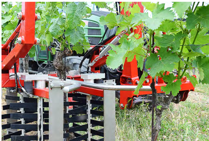
Der Überzeilen-Stockputzer arbeitet mechanisch und effektiv.
